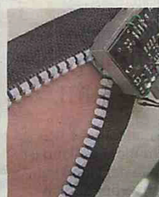
Zipperbot Der Prototyp öffnet und schliesst den Reissverschluss selbständig.
